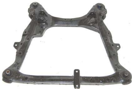
Figure 10.4.1.i.: 2009 Toyota Venza Subframe 26.992 kg (Steel)
