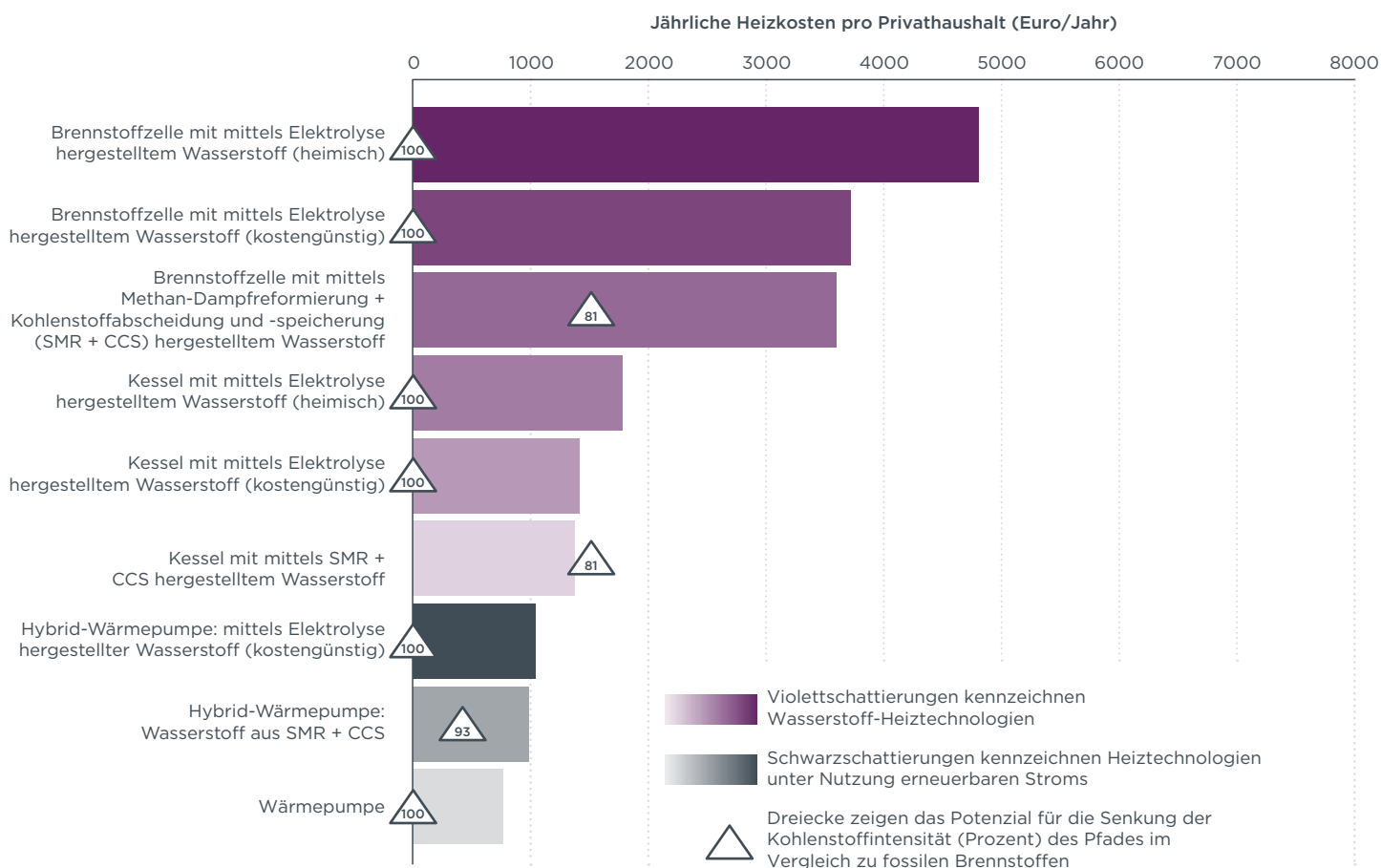
Abbildung 1. Kostenvergleich (in Euro) und Potenzial zur Senkung der Treibhausgasintensität verschiedener technologischer Optionen zum Beheizen eines Privathaushalts während eines Jahres in Deutschland im Jahr 2050
