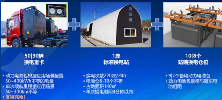
徐州一号换电站是全国首个城市新能源渣土车换电运营示范项目。整个换电过程仅5分钟，全过程实现智能化操作，无人干预。目前在运营车辆90台，根据徐州市政府计划2025年完成徐州市主城区的1500余量渣土车全部替换为换电纯电动渣土车。
