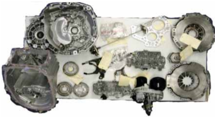
Abb. 2: Beispiel für eine tear-down Kostenanalyse bei einem Fahrzeuggetriebe.
