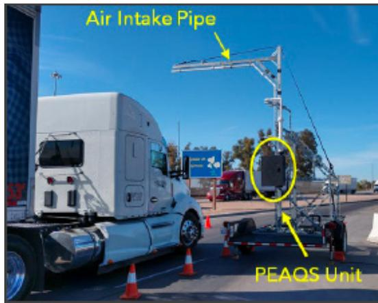
图9. CARB的柴油卡车遥感监测系统
