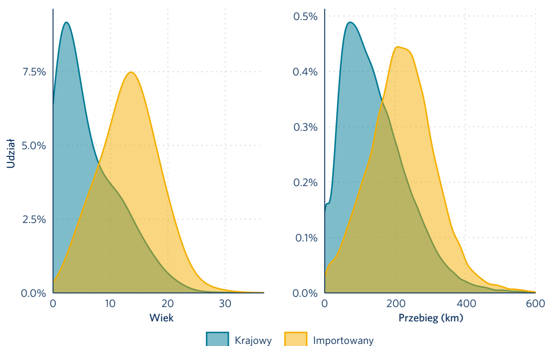
Rysunek 14. Rozkład wieku i przebiegu lekkich pojazdów importowanych i krajowych w Warszawie. Należy zauważyć, że skale osi y dla dwóch wykresów gęstości są różne.
