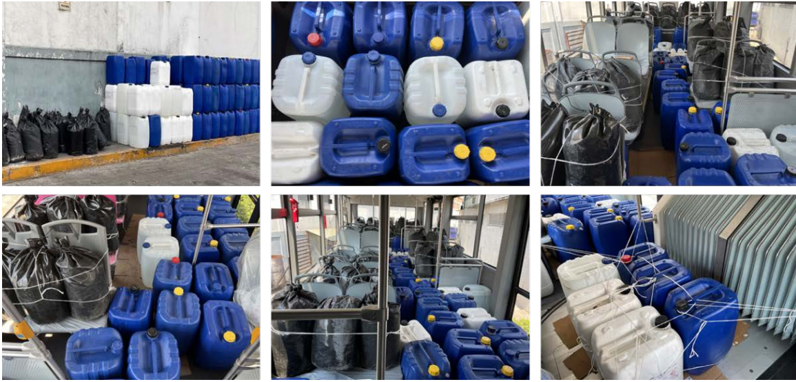
Figura 4. Material y lastrado del vehículo.
