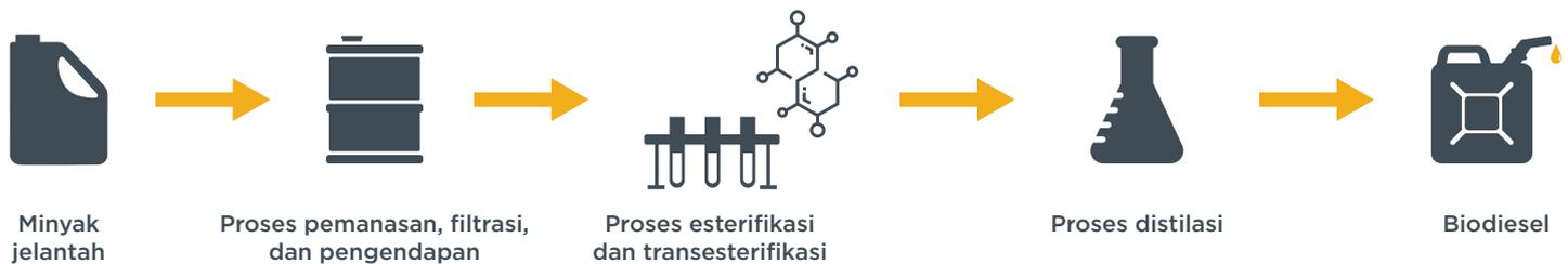
**Gambar 2.** Proses produksi biodiesel minyak jelantah yang umum ditemukan di Eropa
