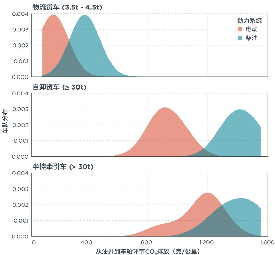
图7. 2021年广东省三类典型货车车队从油井到车轮环节的二氧化碳排放（电动货车与柴油货车对比）
