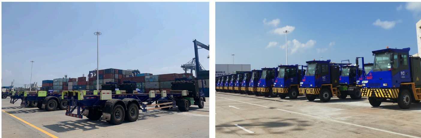
图1 海南省纯电动偏置码头牵引车
