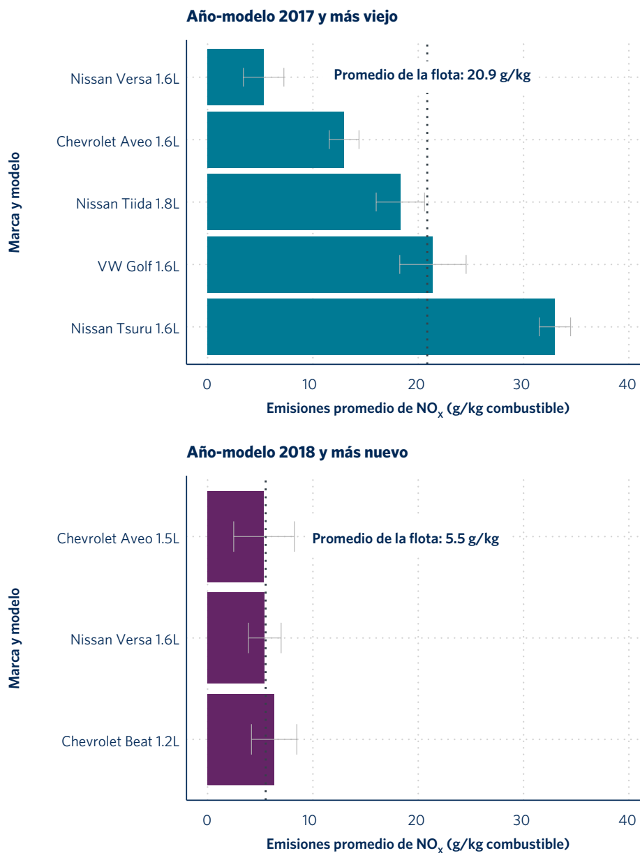
Figura B3. Emisiones de NO x por marca y modelo de taxi. Las barras de error representan intervalos de confianza del 95%.
