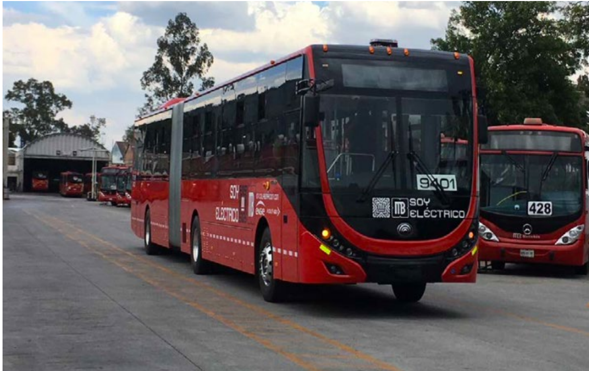
Figura 7. Bus eléctrico articulado Yutong modelo E18-ZK6180BEVG 6
