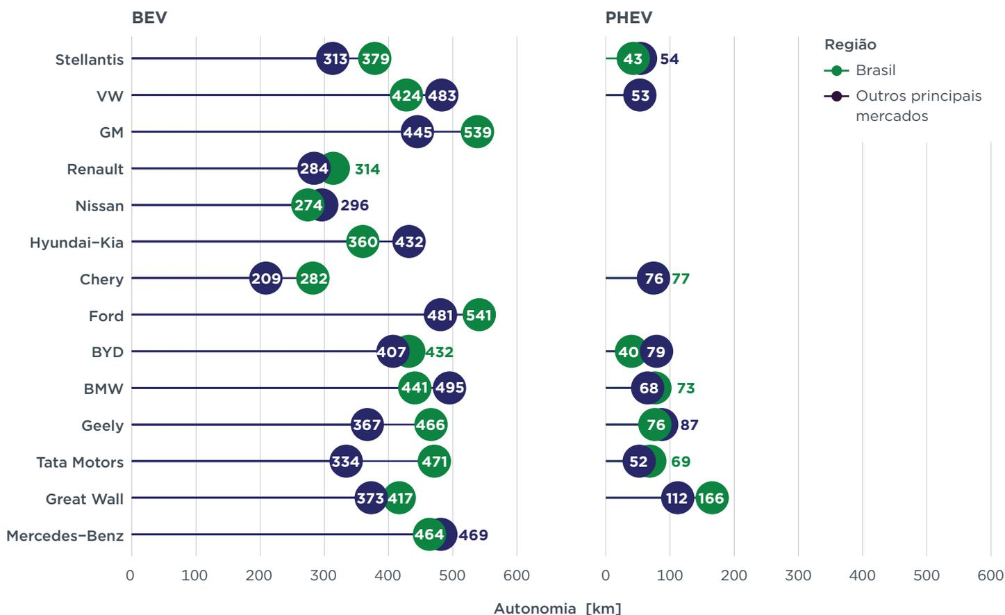
Nota: Na figura, a autonomia representa a autonomia média para cada montadora, calculada usando a autonomia pela referência do WLTP e ponderada por vendas de cada modelo.
